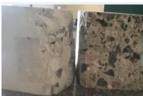
Hình 3.28. Vết nứt của dầm bê tông xi thép trong sơ đồ uốn 4 điểm
