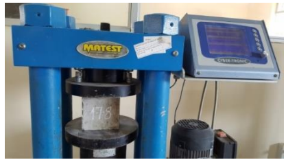
Hình 3.2. Thí nghiệm cường độ chịu nén
