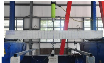
Hình 4.3 Thí nghiệm uốn 3 điểm với dầm BTCTXT
