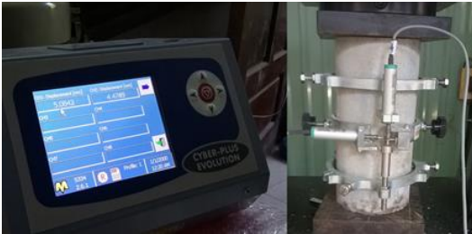
Hình 3.5. Thí nghiệm xác định module đàn hồi và hệ số poisson
