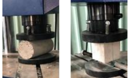
Hình 3.6. Thí nghiệm xác định cường độ chịu kéo khi ép chế
