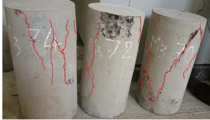
Hình 5.11. Quan sát vết nứt trên mẫu thí nghiệm số và mẫu thí nghiệm thực nghiệm
